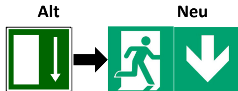
Rettungsweg/ Notausgang mit Richtungsangabe
