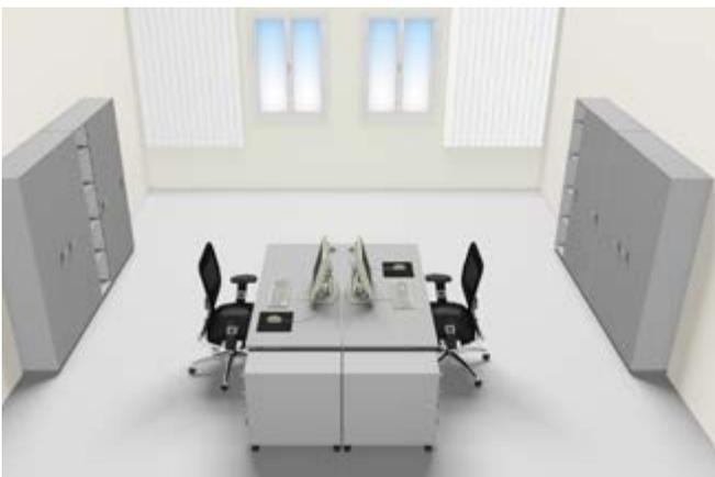
Abb. 45 Richtige Ausrichtung der Bildschirmarbeitsplätze zum Fenster
