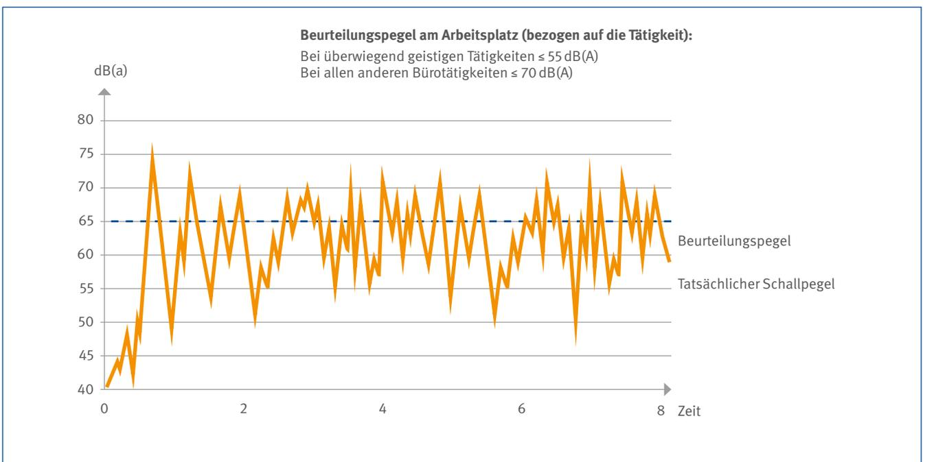
Abb. 47 Lärmmessung im Büro und Messergebnis (Beurteilungspegel)
