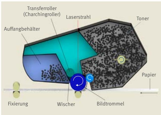
Abb. 39 Prinzip des Laserdruckers
