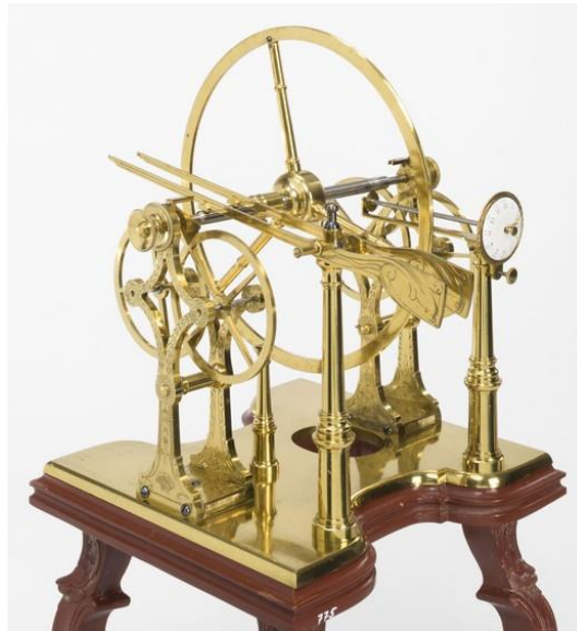
Abb. 2 Detailansicht Atwoodsche Fallmaschine Inventarnummer: 775 Gründungssammlung des Deutschen Museums. Bearbeitet von Julia Bloemer und Benjamin Mirwald, Version vom 02.07.2018, Lizenz Bild & Text: CC BY-SA 4.0.
