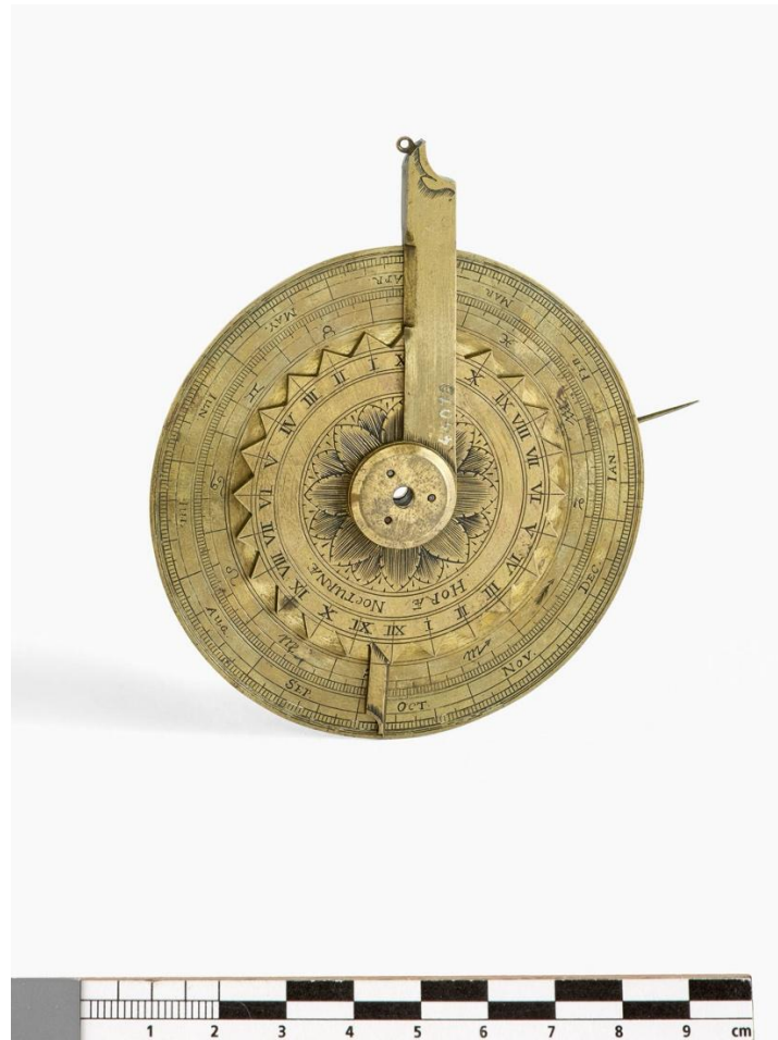
Fig. 6 Nocturnal mit ewigem Kalender, C. C. Schindler, 1705, Brass. Source: Deutsches Museum, Munich, Inv.-Nr. 44070. © Konrad Rainer (CC BY-SA 4.0).
