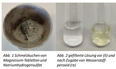
Abb. 1 Schmelzkuchen von Magnesium-Tabletten und Natriumhydrogensulfat
