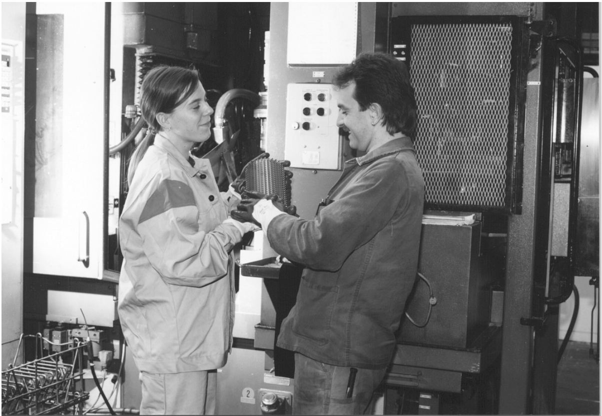
Abb. 25: Eine Auszubildende und der Ausbildungsbeauftragte beim Wechsel eines Wälzfräasers
