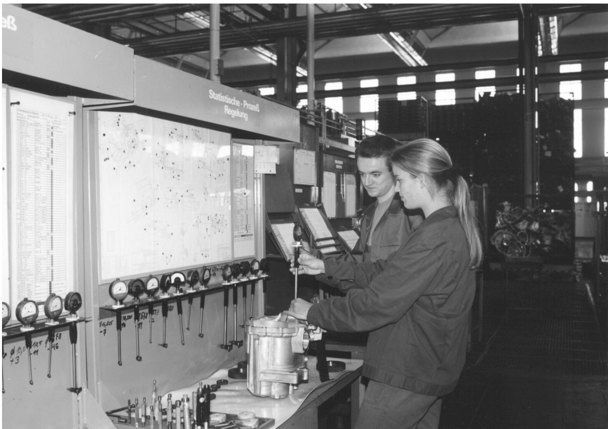
Abb. 26: Auszubildende bei der Qualitätssicherung. Mit Hilfe der statistischen Prozessregelung (SPR) wird an verschiedenen vorgegebenen Punkten die Einhaltung von Toleranzen geprüft
