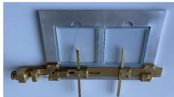
Das von den Studierenden Bastian Radde und Julius Hansen-Flüh nachgebaute Stereomikrometer der Weltmarke Carl Zeiss.
